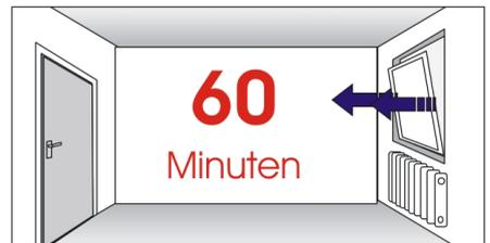
Lüftungsdauer für einen vollständigen Luftaustausch im Raum - je nach Lüftungsart. Lüften mit Durchzug geht besonders schnell und spart Energie. Mit gekippten Fenstern kühlt die Innenwand um das Fenster zu stark ab und Feuchtigkeit kann daran kondensieren. Schimmel ist die Folge.
